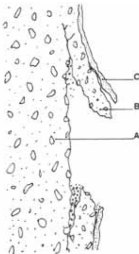
Esempio dei distacchi e decoesioni dell'intonaco e del film pittorico (A intonaco, B intonachino, C film pittorico)
